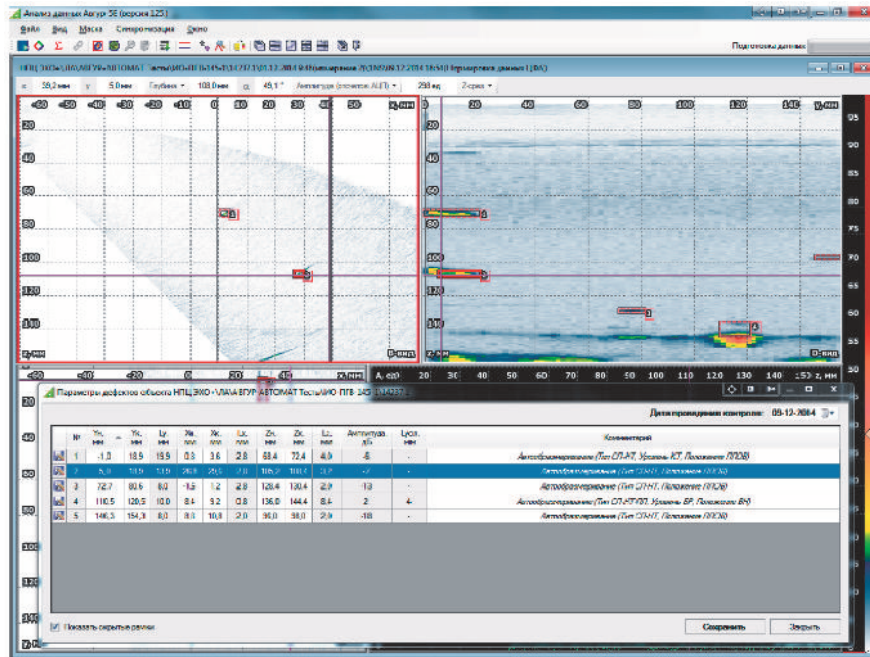
Рис. 6. Пример работы алгоритма автоматического поиска дефектов по данным АУЗК в сварном соединении толщиной 145 мм
