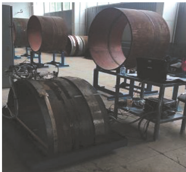
Рис. 6. Проведение АУЗК «слепых» образцов сварных соединений
