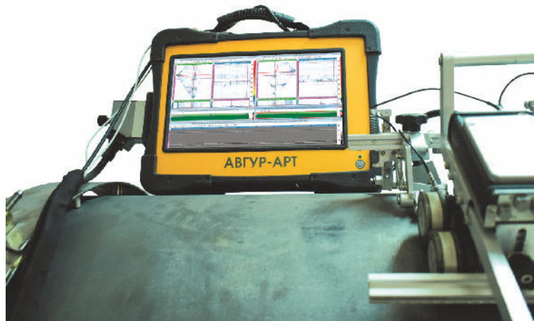
Рис. 15. Дефектоскоп со сканером для контроля сварных швов
