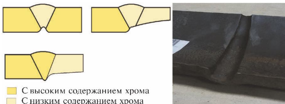
Рис. 1. Примеры эрозионно-коррозионного износа в области композитных сварных соединений и околошовной зоны
