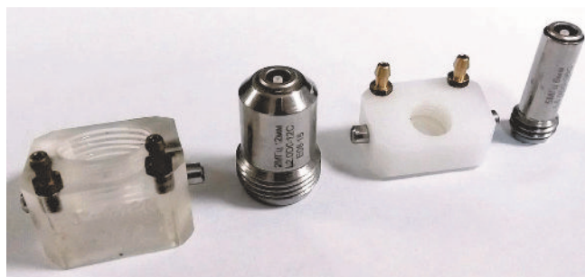
Рис. 2. Призмы и ПЭП TOFD производства ООО «НПЦ «ЭХО+»
