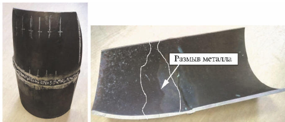
Рис. 23. Фотография образца с реальным ЭКИ
