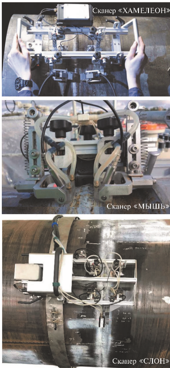
Рис. 3. Сканеры производства ООО «НПЦ «ЭХО+» для проведения контроля по технологии TOFD (ручной, механизированный и автоматизированный)
