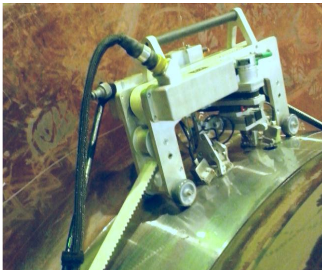
Рисунок 8 – Фото сканирующего устройства в процессе контроля
