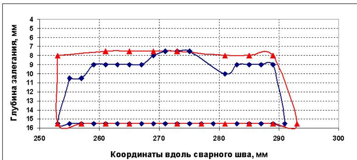
Рис. 7. Профиль дефекта в сварном шве, полученный программно по данным, измеренным с использованием системы Авгур в 1999 г. ( — ) и в 2001 г. ( — ).
