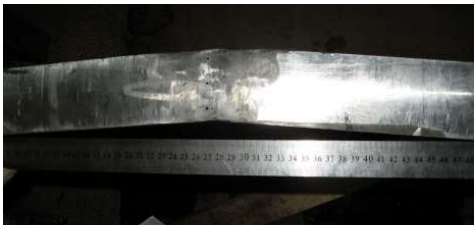
Рис. 5. Образец с пластинами, сваренными под углом 5°.
