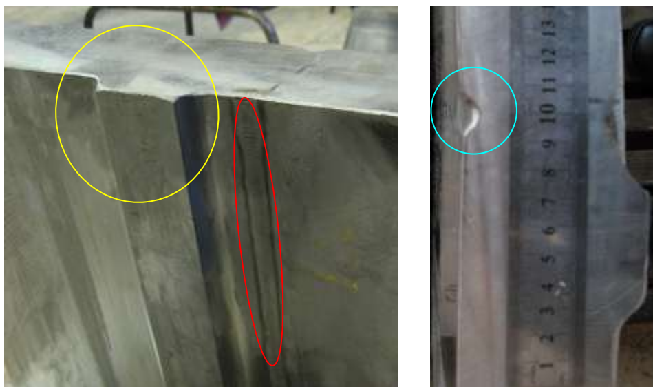
Рис. 6. Один из образцов. Дополнительный валик шва в нижней части показан красным овалом, отсутствие металла в области шва показано голубым овалом, и фрагмент ребра жесткости показан желтым овалом.
