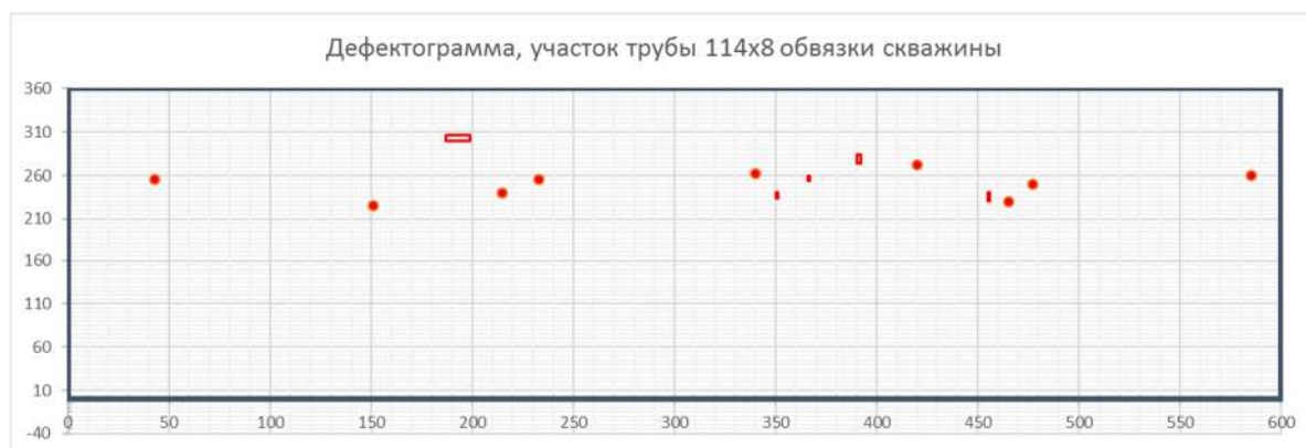
Рисунок 9 – Дефектограмма участка трубы
