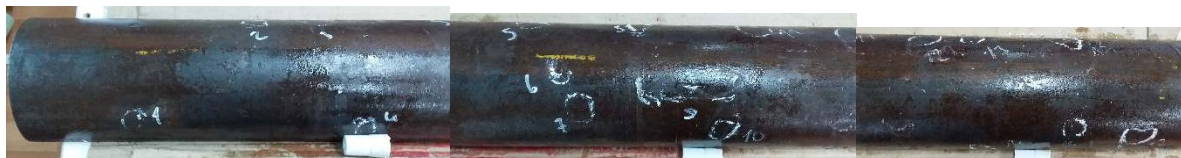
Рисунок 5 – Испытательный образец №3 с нанесенной разметкой выявленных дефектов
