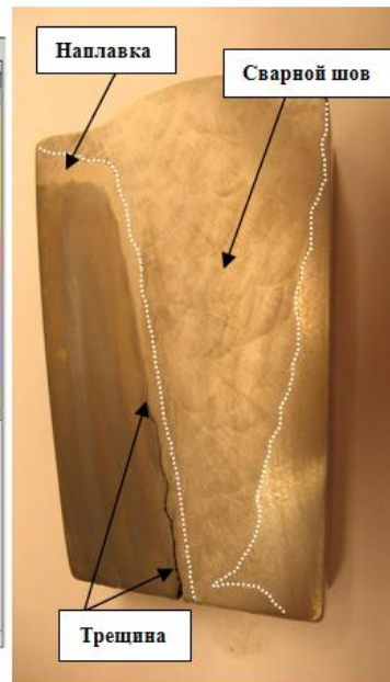
Фотография темплета с трещиной, выявленной по результатам АУЗК СС Ду1100
