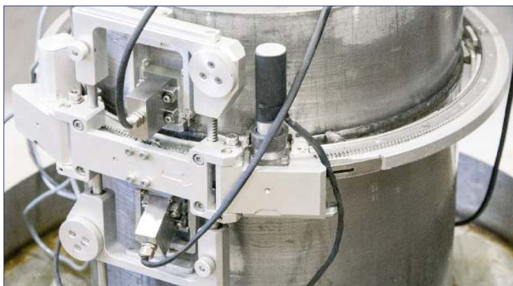
Конфигурация для двухстороннего доступа к сварному шву
