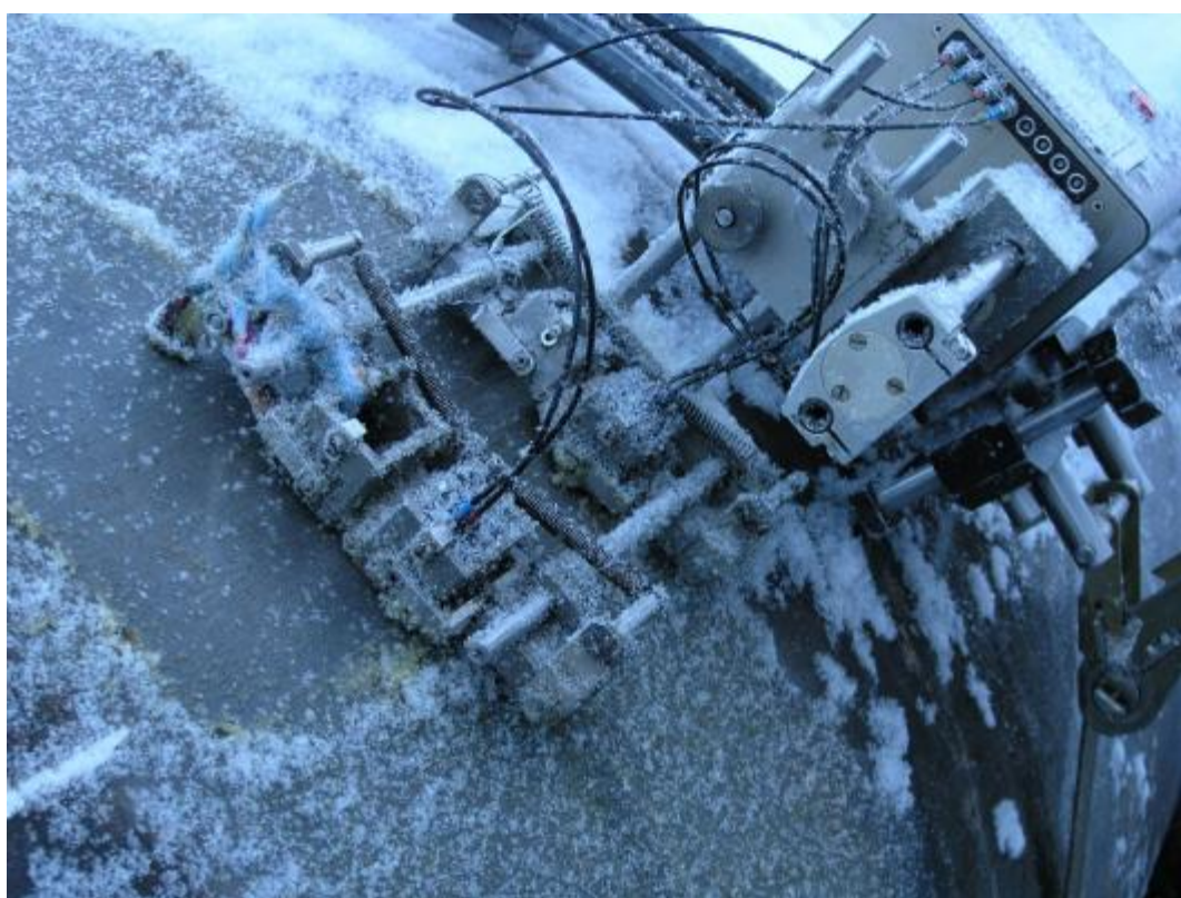
Сканер для контроля трубопроводов диаметром от 500 до 1400 мм.
