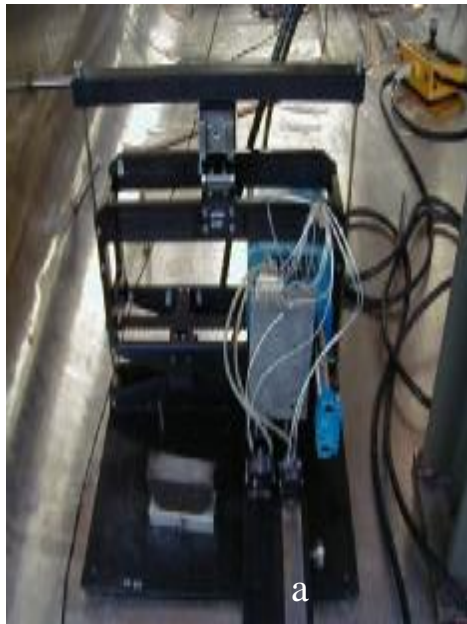
Рис.3. Стенд для калибровки ПЭП. На переднем плане видны стандартные образцы СО-2 и СО-3[4]. Импульсная и спектральная характеристики, диаграмма направленности. ПЭП с углом ввода \approx 60^\circ и \approx 45^\circ . Сдвиговые волны (два левых изображения), продольные волны (два правых изображения).
